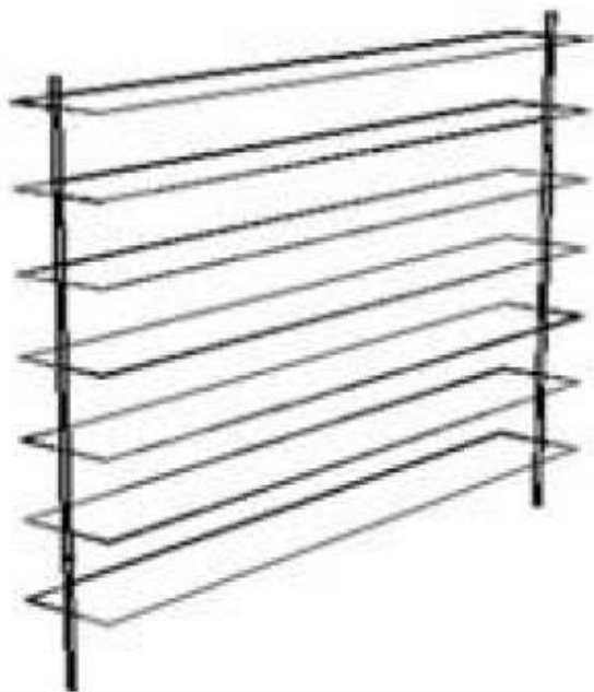
Fig. 12. Estantes de control y redirección de la luz del sol
