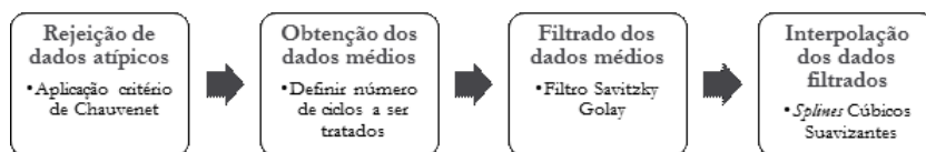
Figura 2. Esquema simplificado do processo de tratamento numérico dos dados da pressão.
