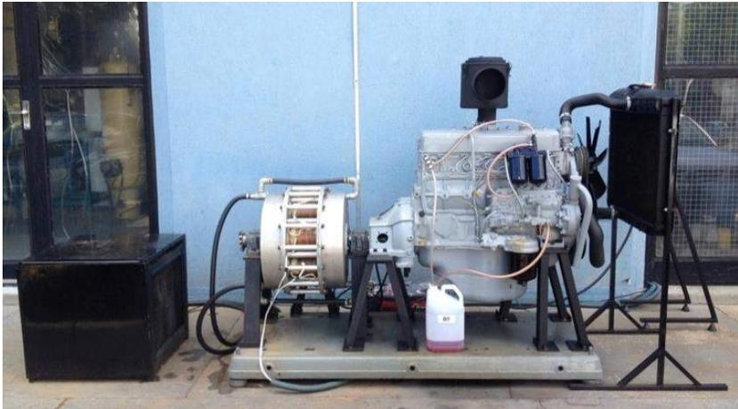
Figura 1. Bancada dinamométrica montada para os testes.
