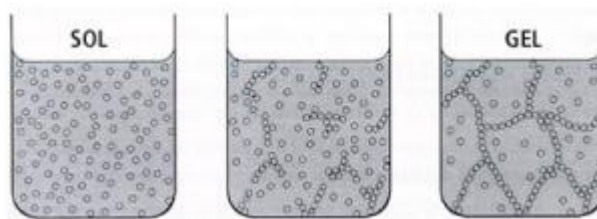
Figura I.2. Conversión del sol a gel por la técnica de sol-gel 206 .
