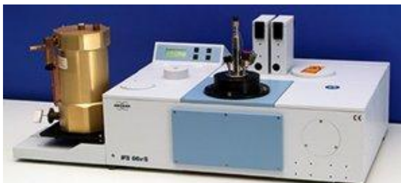
Figura IV. Equipo de FT-IR, modelo Bruker IFS 66s 419 448.
