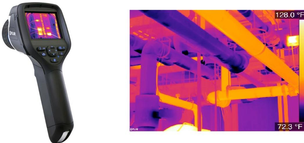
Figura 10 – Câmera termográfica Flir E30 e exemplo de imagem térmica (Merlin Lazer, 2019)
