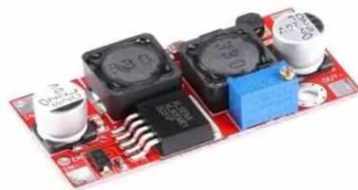
Figura 3.7 - Regulador de tensão X16009. Adaptado de Regulador de tensão, 2017.
