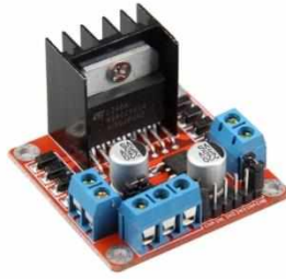
Figura 3.4 - Imagem do driver ponte H L298N utilizado. Adaptado de Ponte H, 2017.
