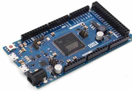
Figura 3.6 - Imagem do Arduino DUE. Adaptado de Arduino DUE, 2017.
