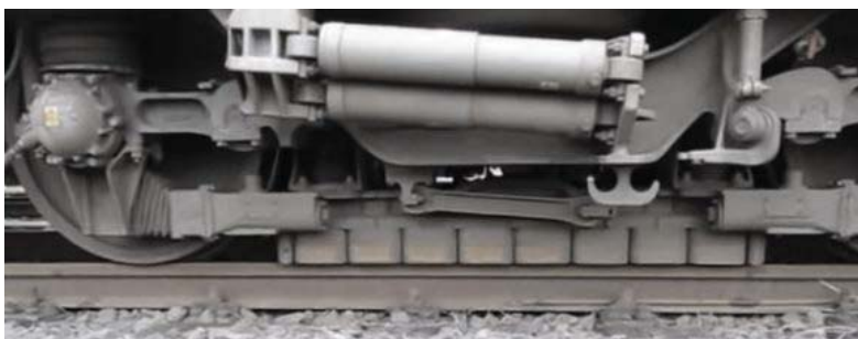
Slika 10. Elektromagnetna kočnica za ICE3 vozilo Figure 10. Electromagnetic rail brake on the ICE3 train
