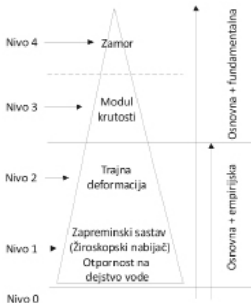
Slika 9.- Struktura specifikacija za asfalt-beton po Francuskim normama (6)
