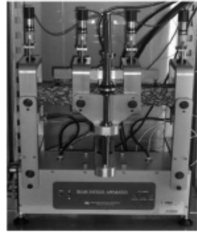
Slika 8.- Uređaj za ispitivanje gredica opterećenih u 4 tačke
