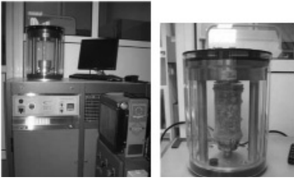
Slika 7.- Triaksijalni aparat sa ćelijom za ispitivanje uzoraka
