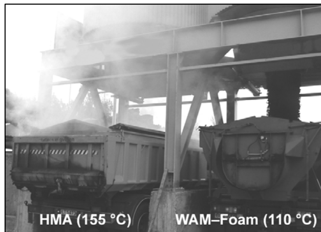
Слика 7. Истовремено пуњење камиона конвенционалном мешавином по врућем поступку (HMA), и мешавином произведеном по WAM-Foam технологији [9]
