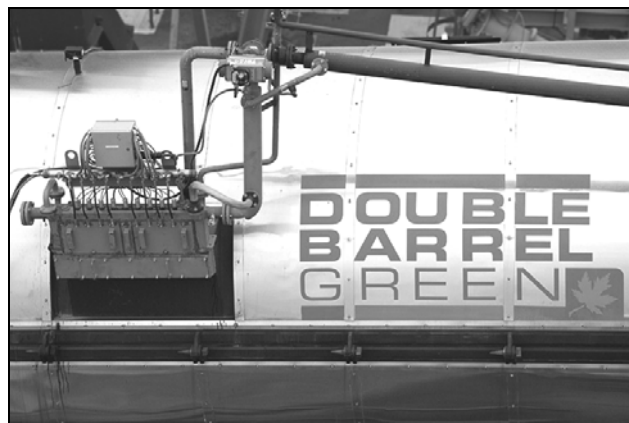
Слика 8. Double-Barrel Green бубањ за сушење и мешање [12]
