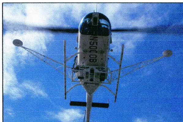
Сл. 3. Хеликоптер опремљен за алтиметријско снимање
