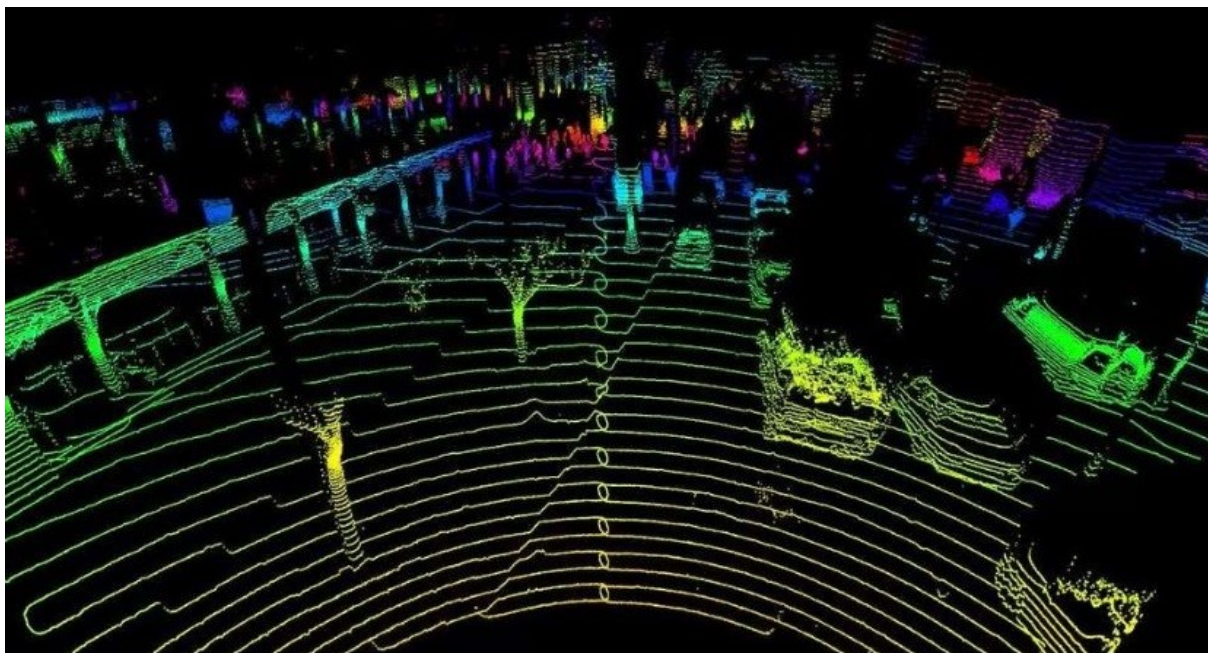
Obrázek 9 obrázek prostředí pomocí LIDARU [9]
