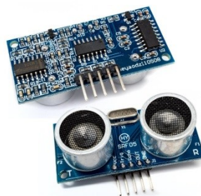
Obrázek 47 Ultrazvukový měřic vzdálenosti SRF05[21]
