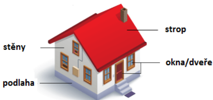
Obrázek 2.1 Znázornění jednotlivých ztrát prostupem tepla 57- upraveno
