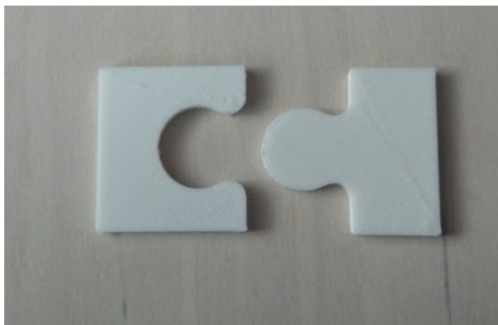
Obr. 27 Varianta spojení č. 5 – puzzle
