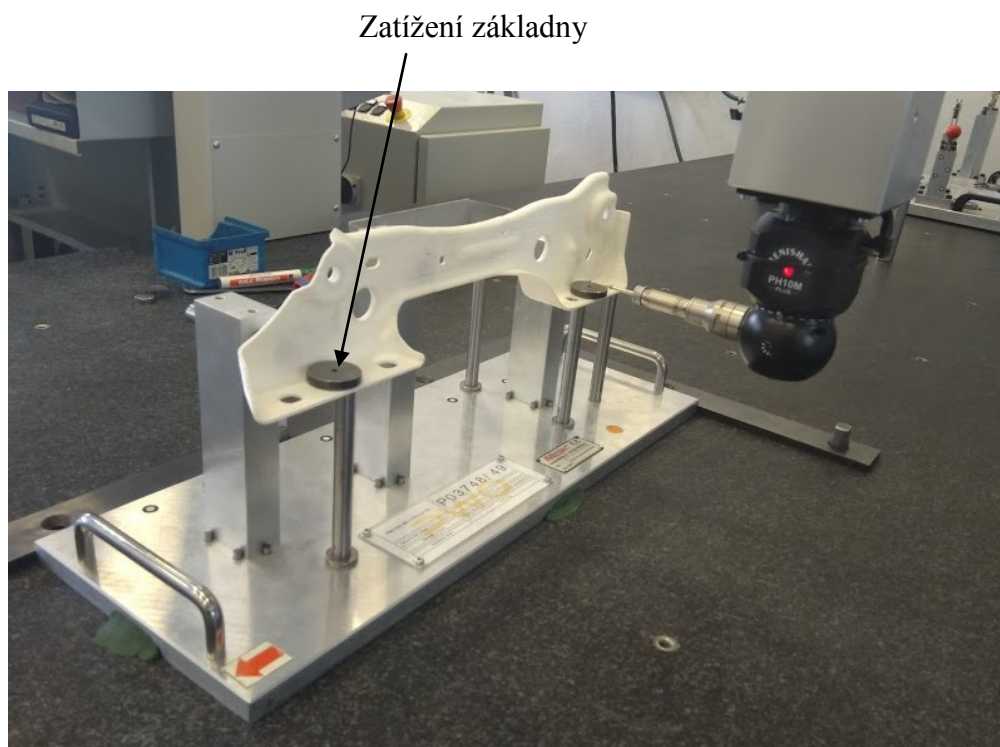
Obr. 40 Průběh měření výrobku se spojem č. 5 – puzzle
