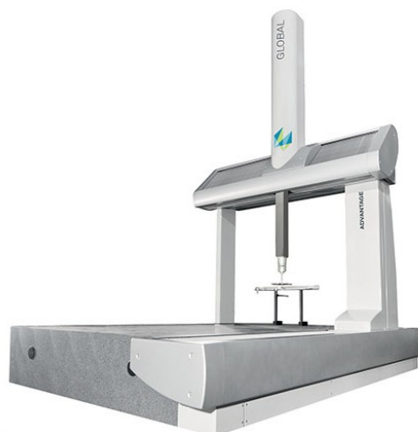
Obr. 8 Souřadnicový měřicí stroj HEXAGON GLOBAL Advantage 21
