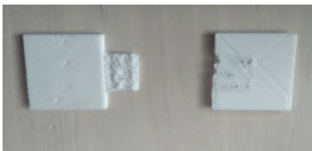
Obr. 22 Zborcené plochy testovacích dílů
