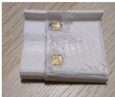
Obr. 29 Obě části dílu spojené pomocí magnetů
