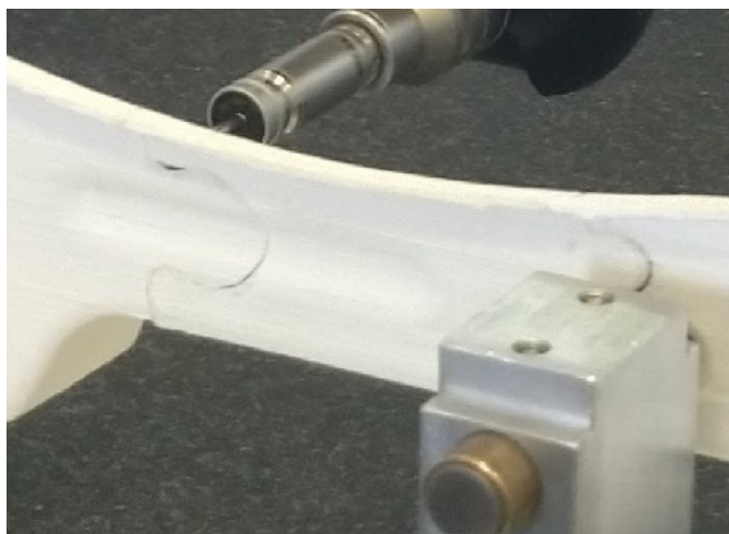
Obr. 41 Nepřesnosti spojek č. 5 – puzzle
