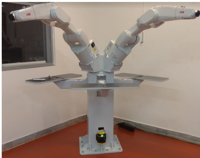
Obr. 8 ABB IRB 1 200 – Současný stav
