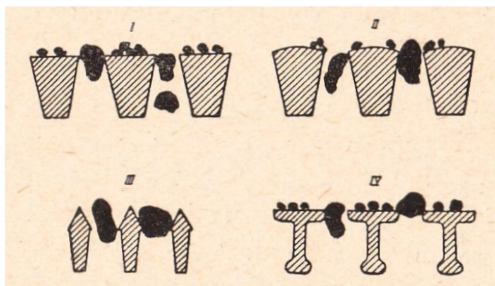
Obrázek 5 Tvary příčných průřezů roštových tyčí [3]
