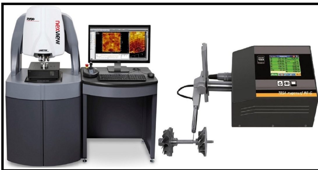
Obrázek 3 – Přístroje pro měření zaoblení, profilometr (vlevo) a drsnoměr (vpravo) 27,28
