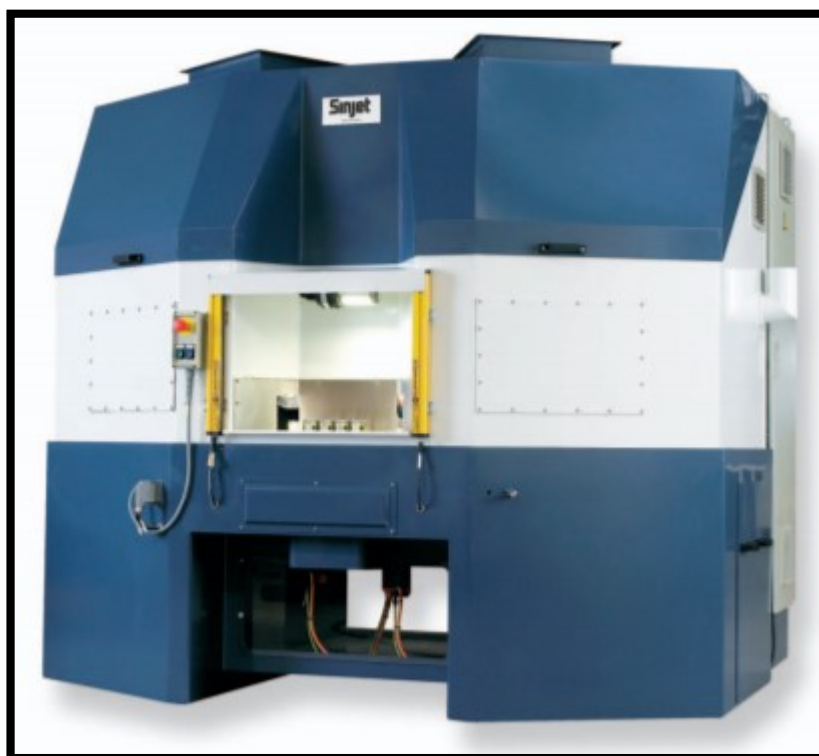
Obrázek 14 – Stroj používaný pro tvorbu zaoblení břitu Sinjet IBX 12 37
