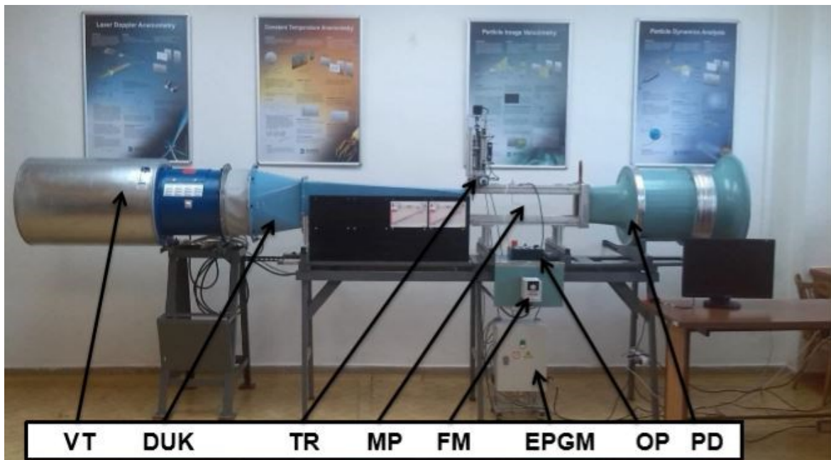
Obr. 3.7 Aerodynamický tunel v laboratoři Katedry hydromechaniky a hydraulických zařízení 13
