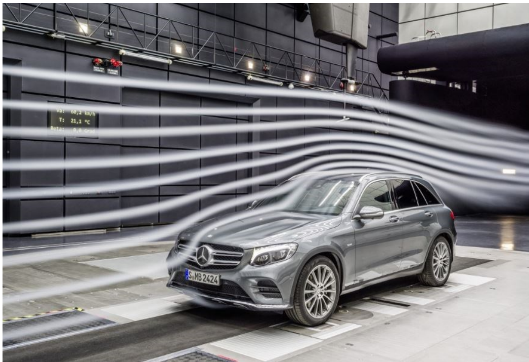
Obr. 3.2 Ukázka vizualizace proudění v tunelu s otevřeným měřicím prostorem 9
