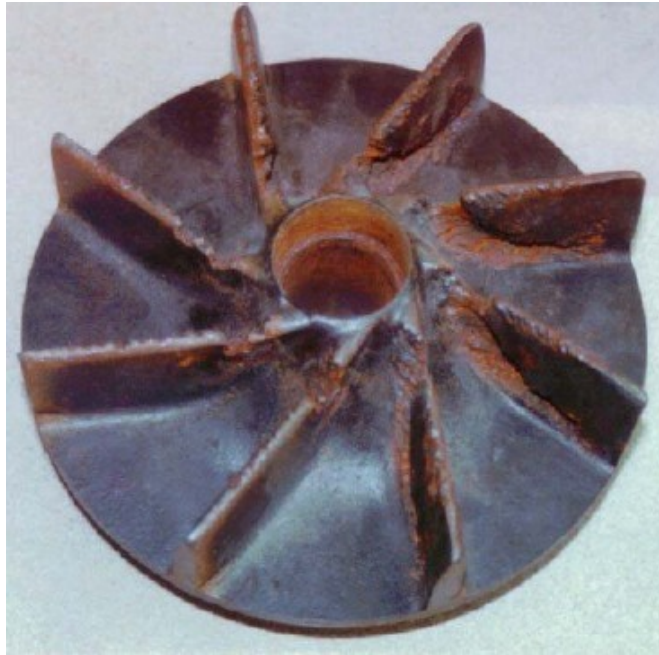
Obr. 1.1 Poškození oběžného kola kavitací [3]
