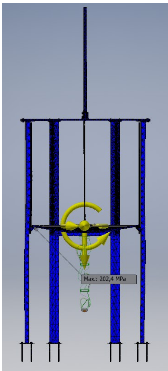
Obr. 46 - Analýza konstrukce pomocí MKP s označeným místem nejvyššího napětí
