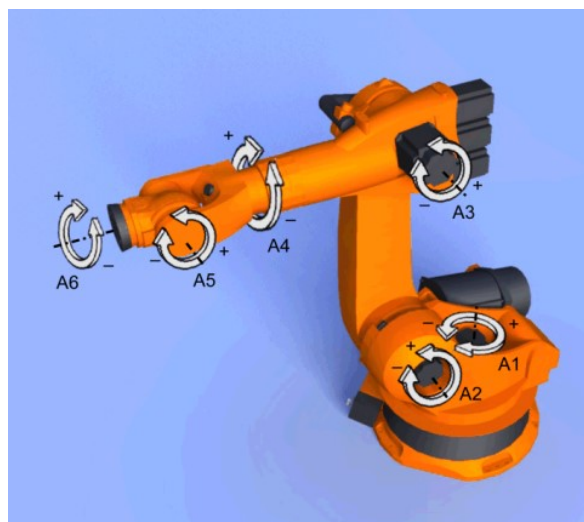
Obrázek 1.2 – Osy robotu [1]
