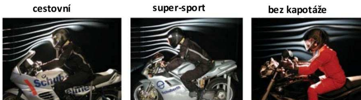
Obrázek 27: Vliv kapotáže na odklon proudu vzduchu na přilbu [6]
