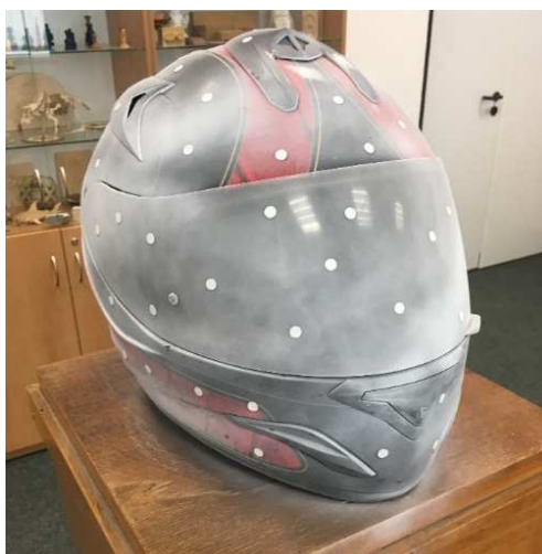
Obrázek 33: Nanesení křídového prachu pro zvýšení odrazivosti laseru [Autor]
