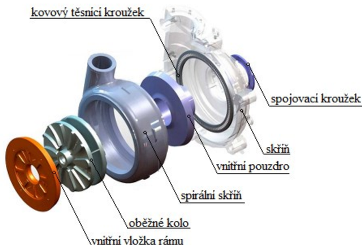
Obrázek 4.1 – Popis části radiálního čerpadla typu WARMAN 14-12 G-G 33 .
