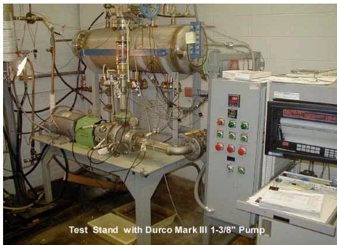
Obrázek 2.3 – Zátěžový test na čerpadle Durco Mark III 2
