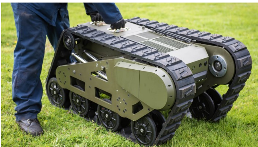
Obrázek 5.1: Ukázková pohonná jednotka zařízení [22]
