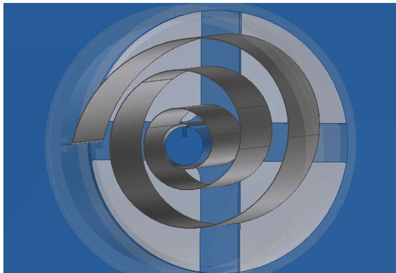
Obrázek 5.9: Příklad použití spirálové/hodinové pružina
