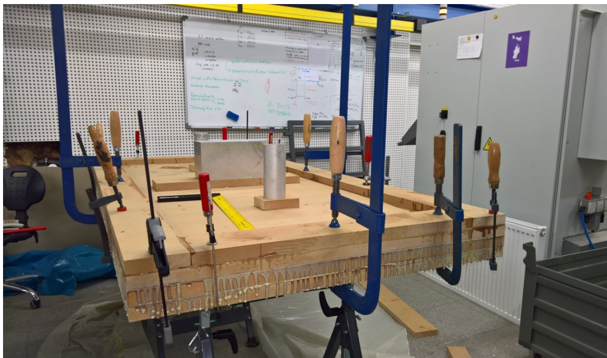
Obr. 34 Slepění a stlačení MDF desky
