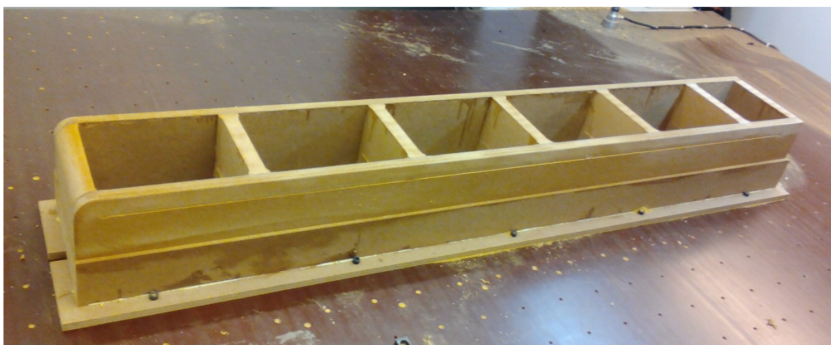
Obr. 36 Podpůrný rám na pravé bočnice (kopyto)
