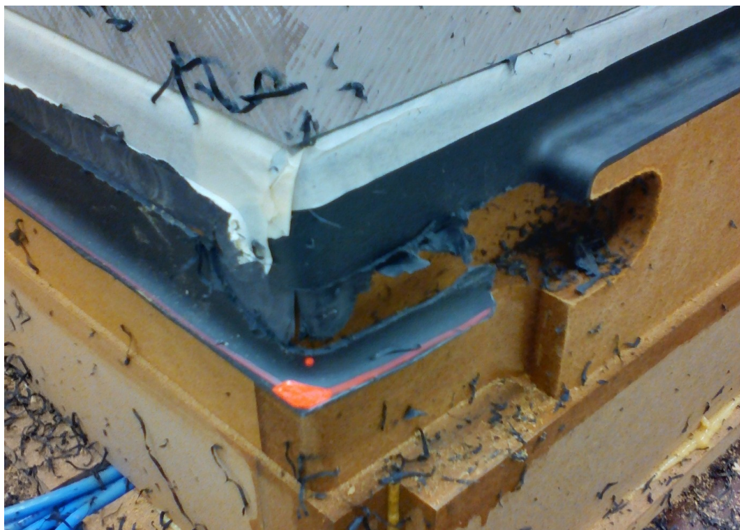
Obr. 51 Nedokonale obrobený zaoblený roh a celá přední hrana
