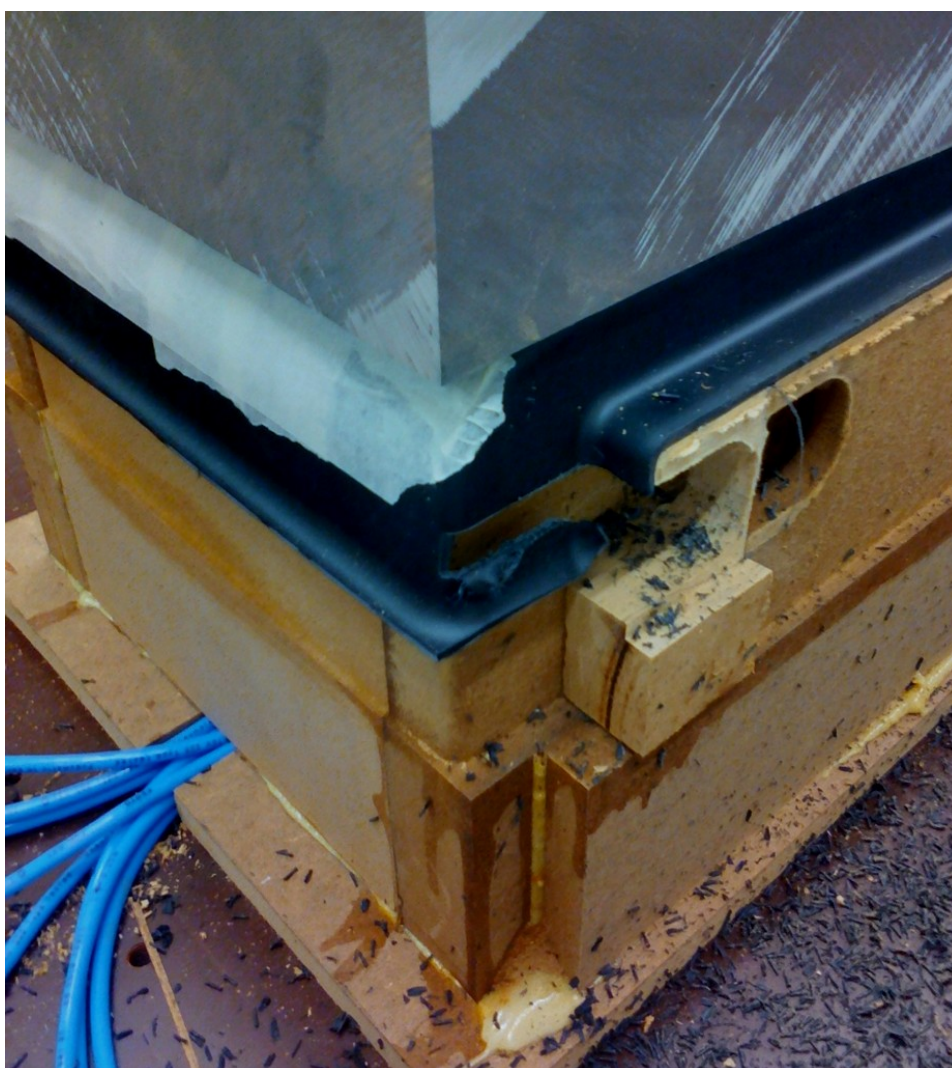
Obr. 53 Vyfrézovaný a zatížený problematický roh dílu
