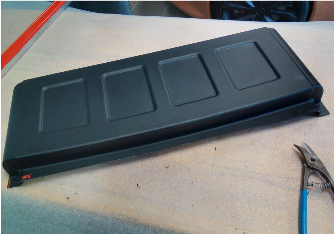
Obr. 30 Výlisek bez technologických přebytků
