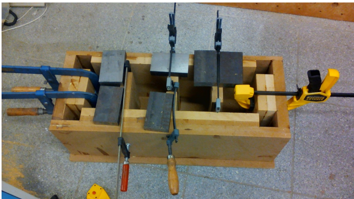
Obr. 35 Spleené a stlačené MDF desky určené k výrobě podpůrného rámu vrchního dílu
