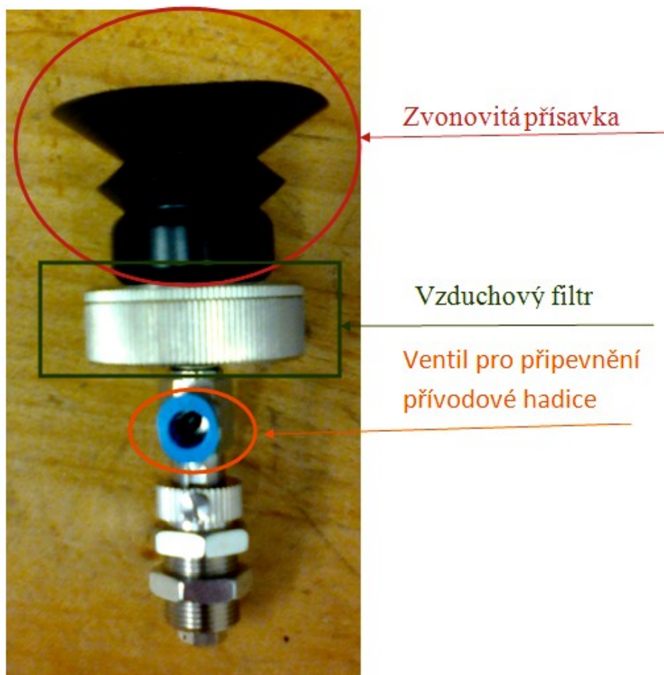
Obr. 48 Popis přísavky typu Festo ESG-50-BN-HD-QS-F
