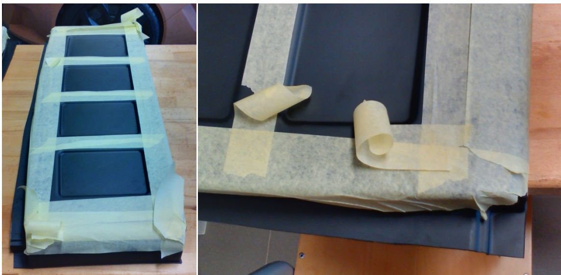
Obr. 32, 33 Výlisek se špatnou páskou a detail odstávání ochranné pásky
