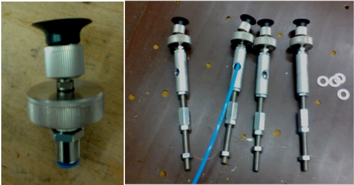
Obr. 45, 46 Typ použité přísavky, Kompletní přísavka před uchycením do frézky
