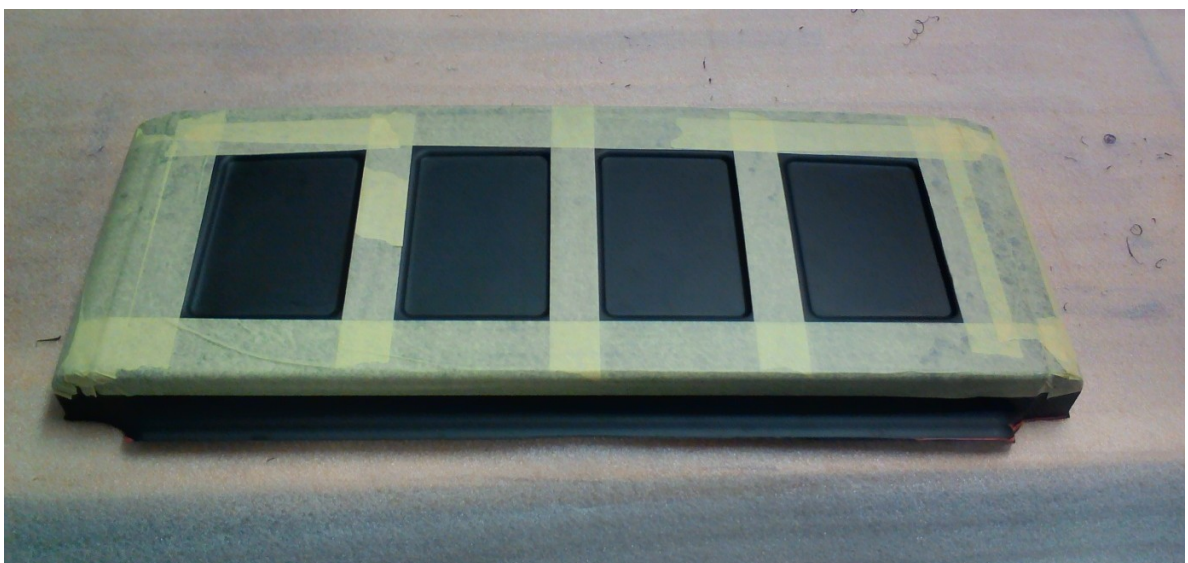
Obr. 31 Výlisek s aplikovanou páskou
