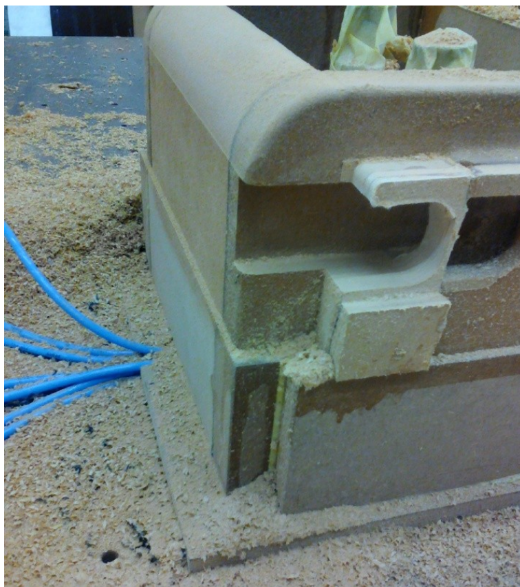
Obr. 42 Rám upravený pro ořez levých bočnic
