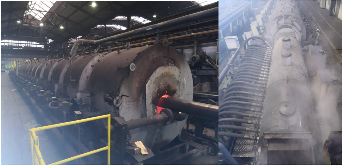
Obr. 10 Vlevo vstup do tunelové pece, vpravo kalicí zařízení
