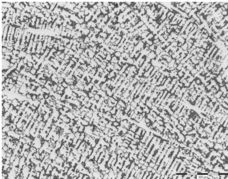
Obr. 15 - Mikrostruktura - leptaný stav
