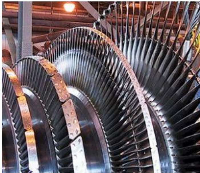
Obr. 13 - Rotační část parní turbíny [18]
