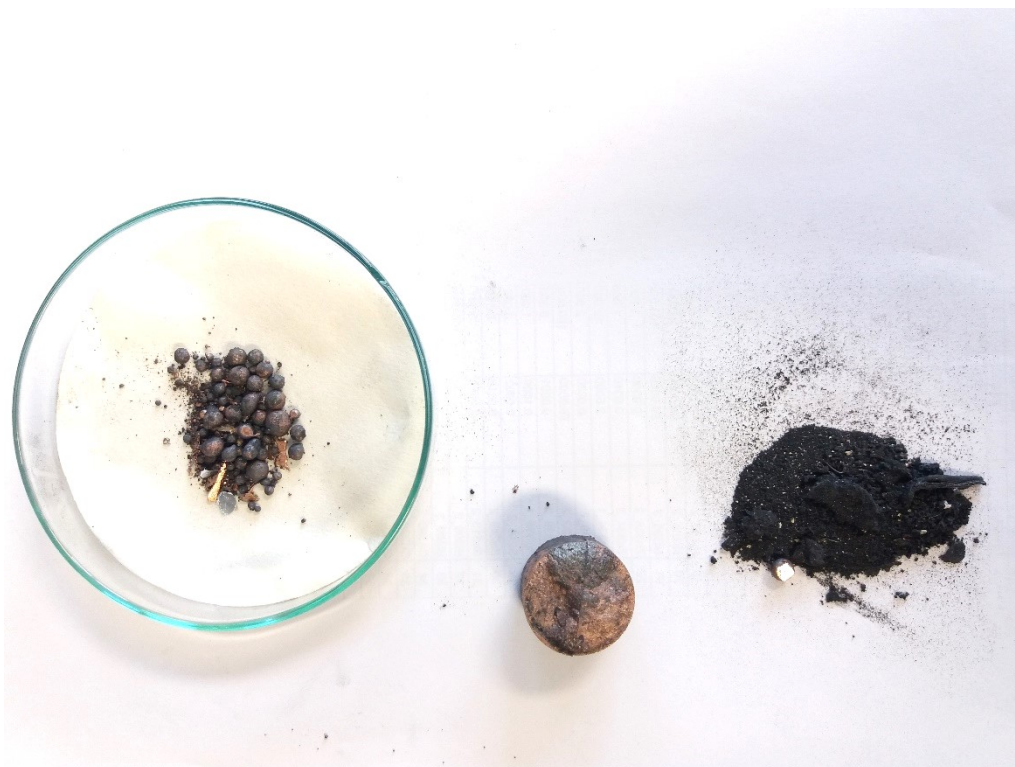
Obr. 34 Výstup z tavení č. 7 – Odlitek, zbytková Cu, LIB hmota
