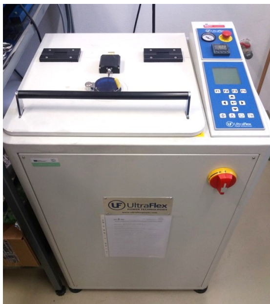
Obr. 20 Indukční pec s odstředivým litím Supercast 13
