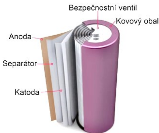
Obr. 6 Průřez válcovou Li-Ion baterií [14]
