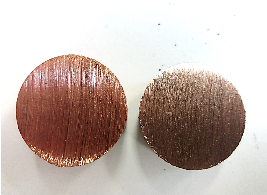
Obr. 36 Srovnání odlitku č. 1 čisté Cu (vlevo) se vzorkem č. 8 (vpravo)
