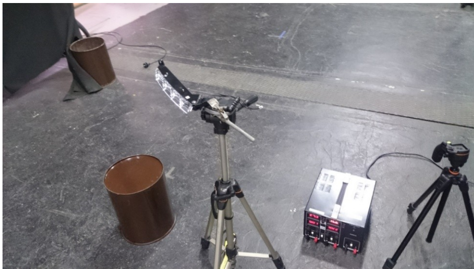
Obr. 42. Uchytenie modulu DRL na podpornom statíve
