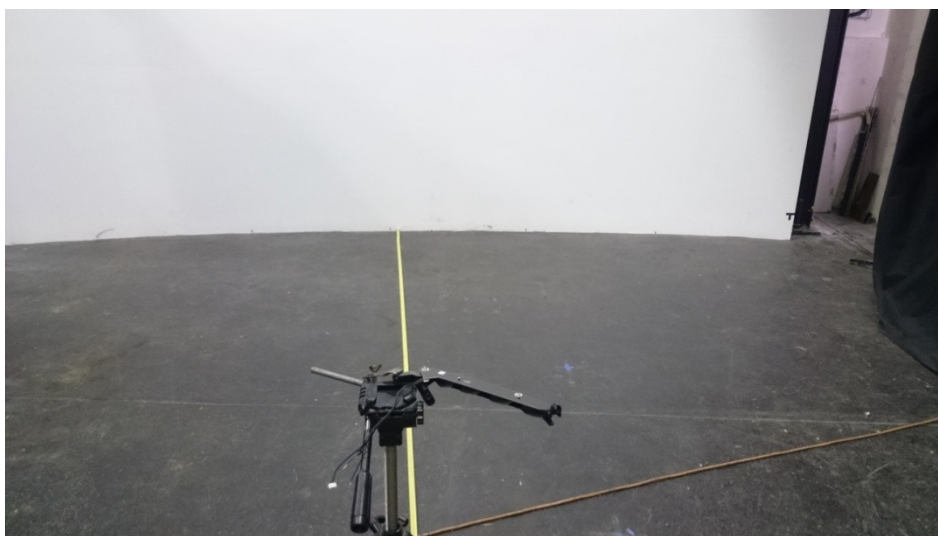
Obr. 43. Uchytenie modulu DRL na podpornom statíve pohľad na stenu na ktorú sa bude premietat' a ktorá bude snímaná.
