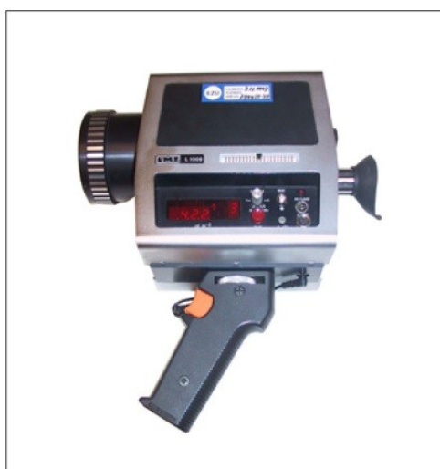
Obr. 8. Digitálny jasomer od Lichtmess-technik typ L1009 [16]
