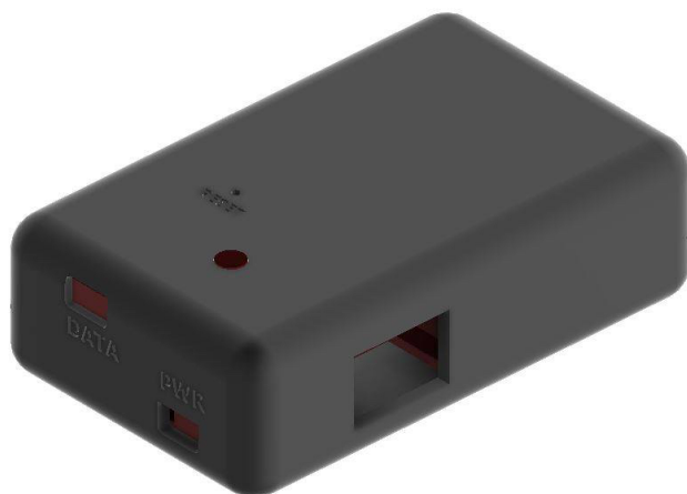
Obrázek 16: Ukázka otvorů krabičky, navrženo v programu 3D CAD.
