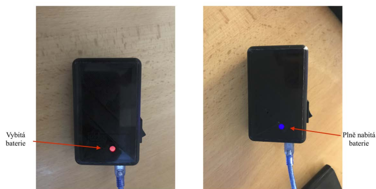
Obrázek 21: Ukázka indikace nabití baterie, vlevo vybitá, vpravo plně nabitá.
