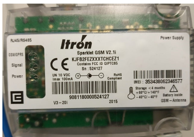
Obr. 12. Itrón Sparklet GSM modul pro Itrón SL7000
