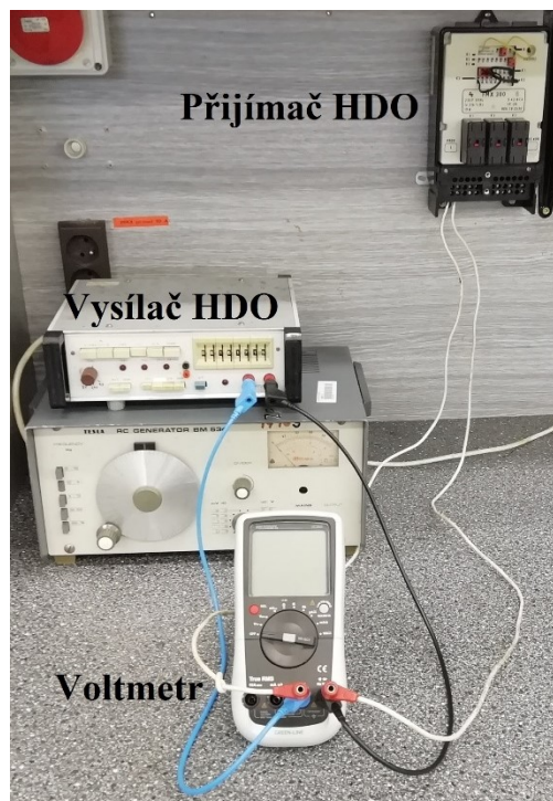
Obr. 26 Ověření přijímače FMX 300, zapojení
