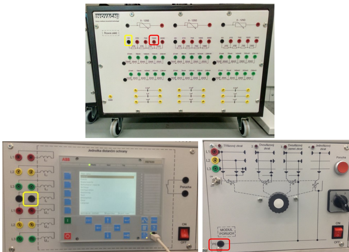
Obr. 7.7 Zapojení odporníků modulu zátěže pro měření závislosti zkratového proudu na odporu uzemnění
