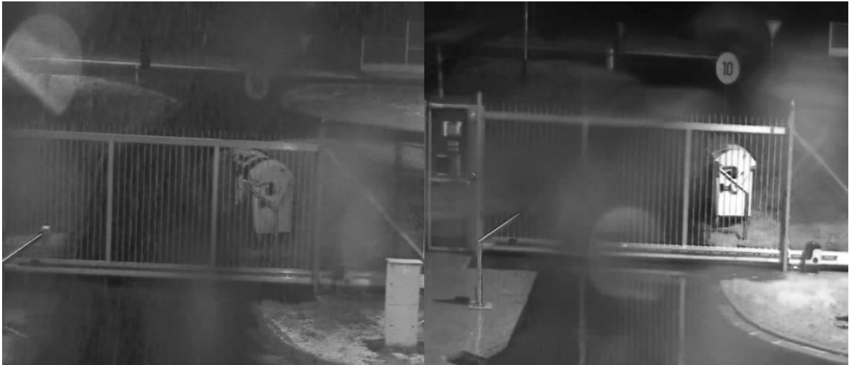
Obrázek 49-kamerové snímky vjezdové brány TR N znehodnocené kapkami vody na krytu kamery
