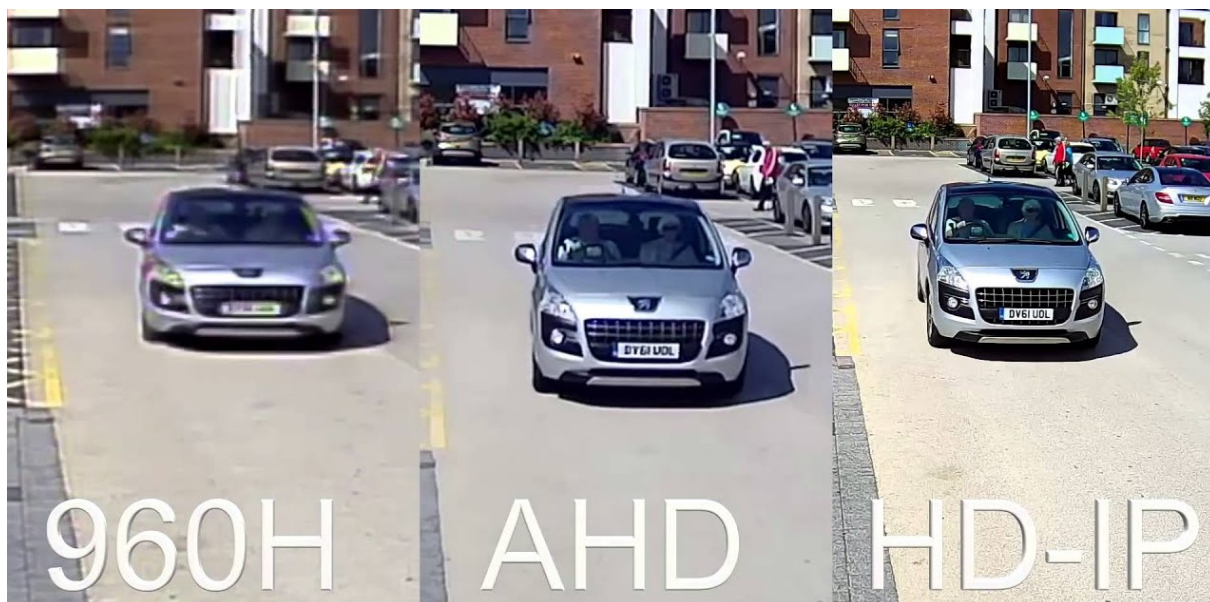
Obrázek 6-rozdíl kvality pořízeného snímku mezi analogovou, AHD a digitální (IP) kamerou [16]
