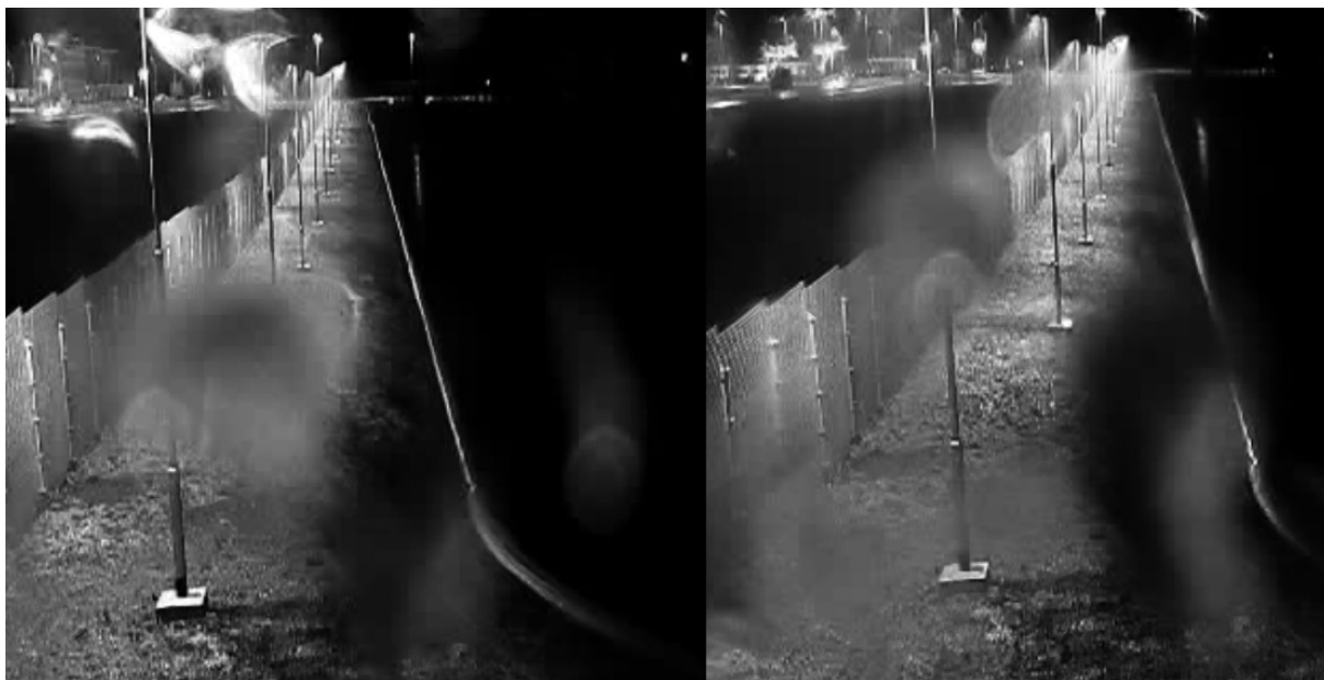
Obrázek 48-kamerové snímky oplocení TR N znehodnocené kapkami vody na krytu kamery
