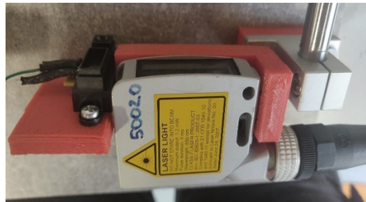
Obr. 17: Uchycení optických senzorů Sharp (vlevo) a Balluff (vpravo)
