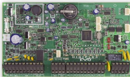
Obr. 1 Deska zabezpečovací ústředny DIGIPLEX EVO192 výrobce PARADOX [29]
