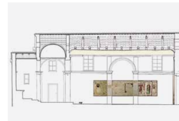
97, 98. Proposta di rimozione degli intonaci sovrastanti gli affreschi con la soluzione "a finestra". Fotopiani dell'arch. Marco Merello.
