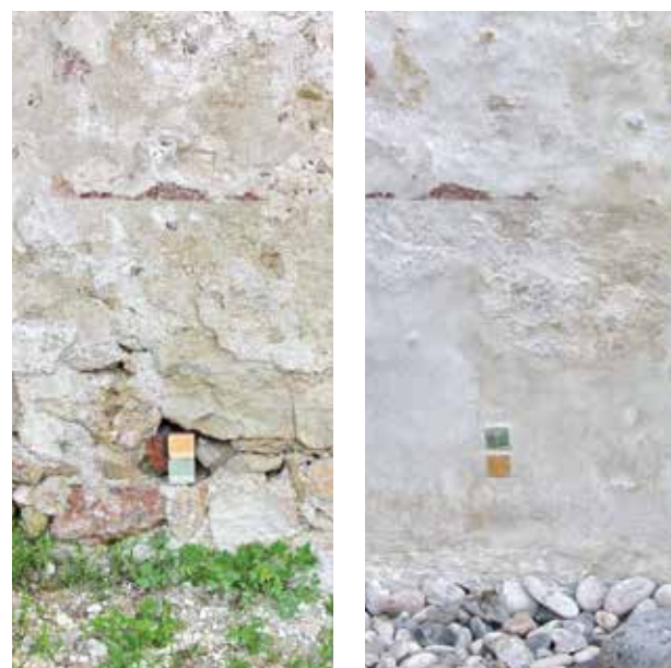
121, 122. Particolare durante e dopo il posizionamento dei campioni trattati con protettivo al silicato di potassio.
