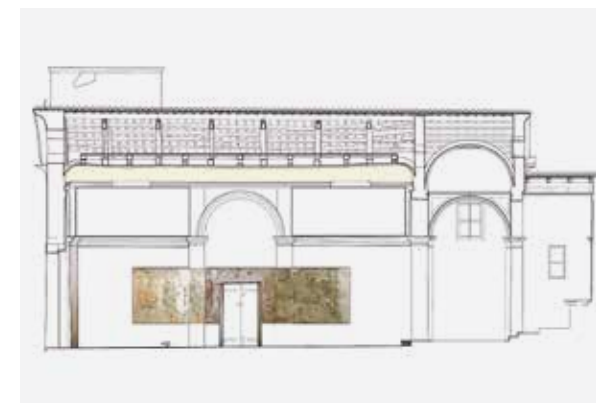
97, 98. Proposta di rimozione degli intonaci sovrastanti gli affreschi con la soluzione "a finestra". Fotopiani dell'arch. Marco Merello.
