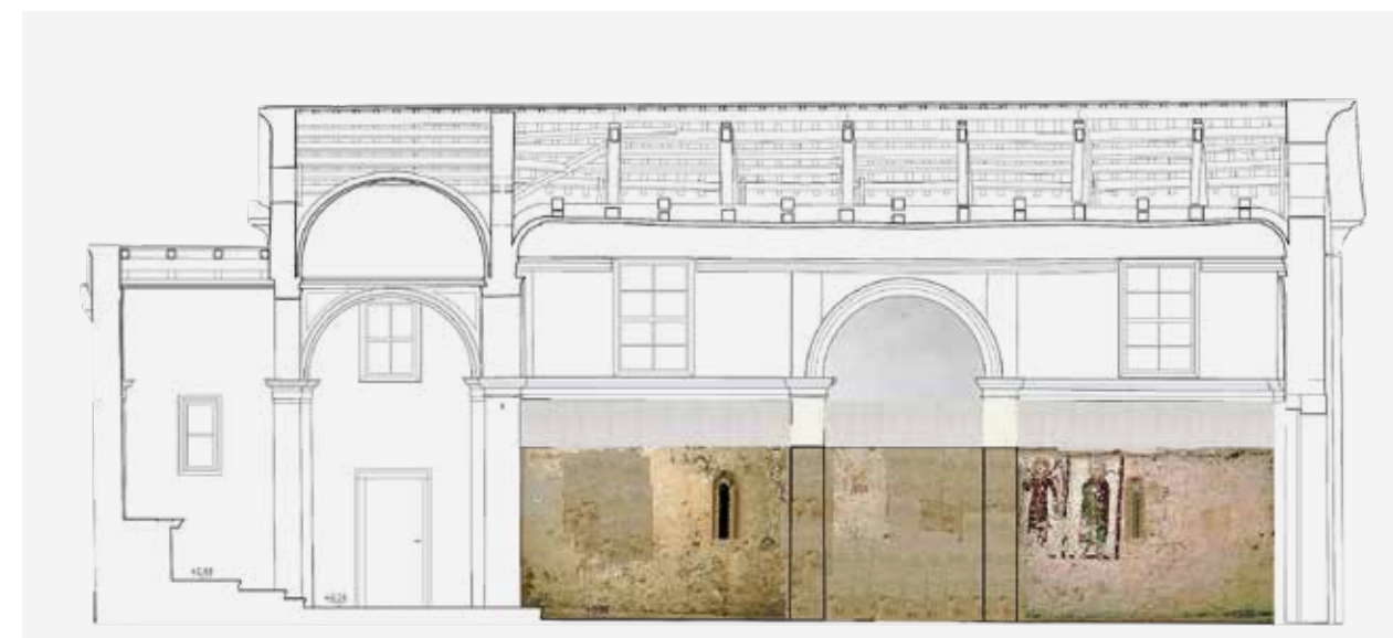
99, 100. Soluzione di rimozione degli intonaci sovrastanti gli affreschi con la soluzione "a taglio". Fotopiani dell'arch. Marco Merello.
