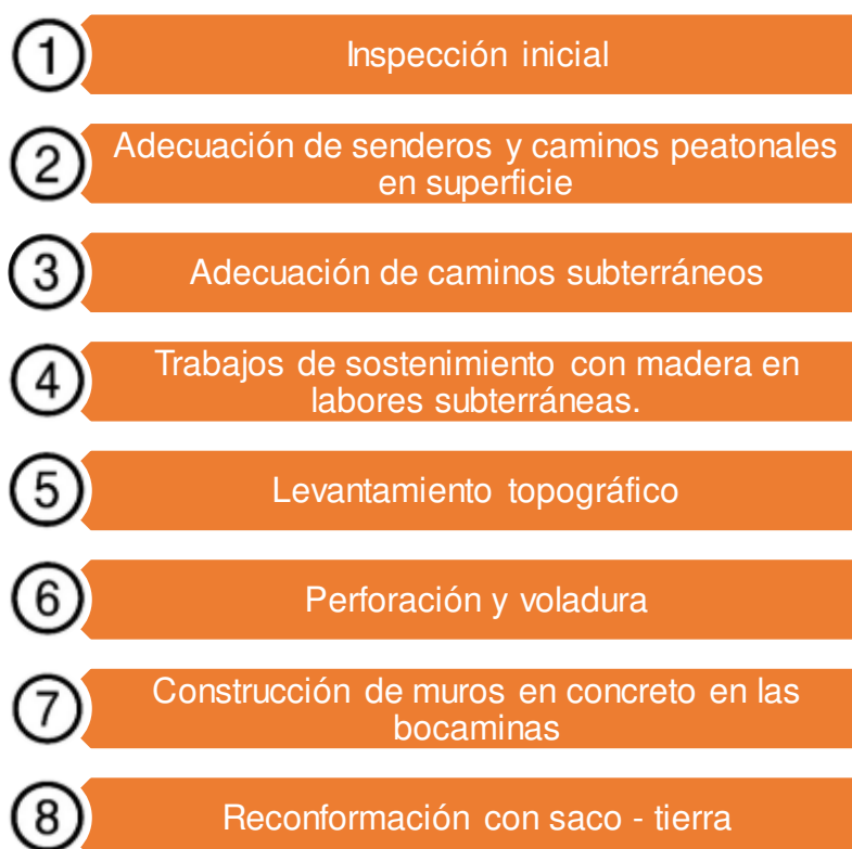
Figura 15. Procedimiento para la ejecución del cierre de minas abandonadas del sector La Bodega.
