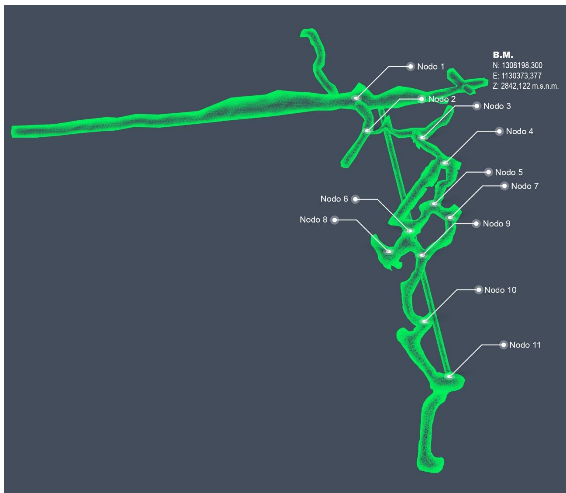
Figura 10. Esquema de labores subterráneas mina Malvinas (nodos)
