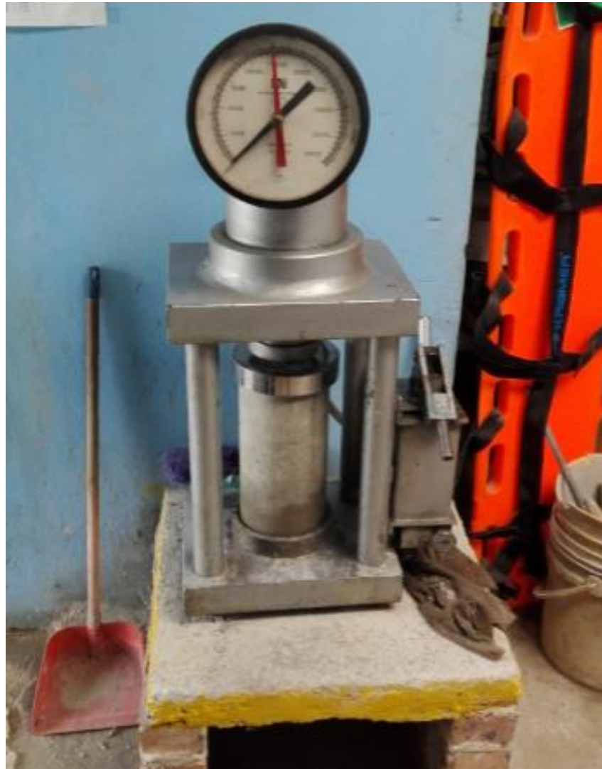
Figura 6. Prueba de resistencia a la compresión de cilindros de concreto, correspondiente al Caisson N°2 del K11+100
