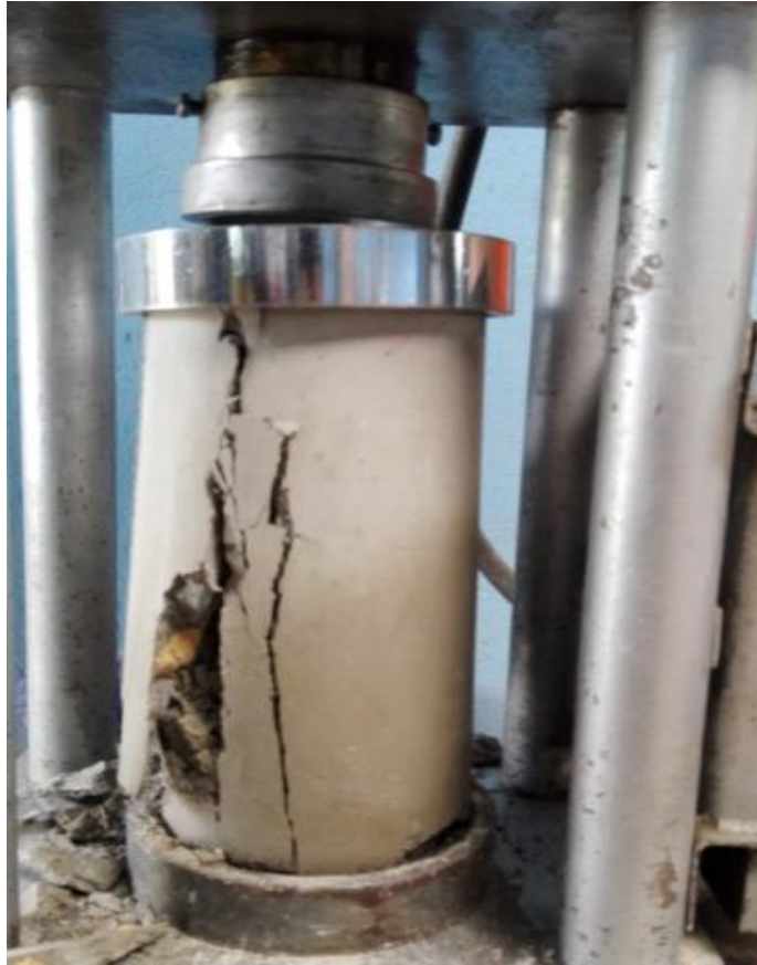
Figura 7. Falla tipo 3 según el INV E-410-13 del cilindro de concreto del caisson N°2 del K11+100
