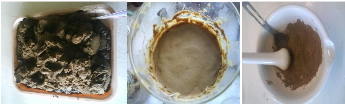
Imagen 5.3. Torta obtenida de proceso de hidrólisis enzimática (izquierda) y extracción etanol-ácido acético (derecha).
