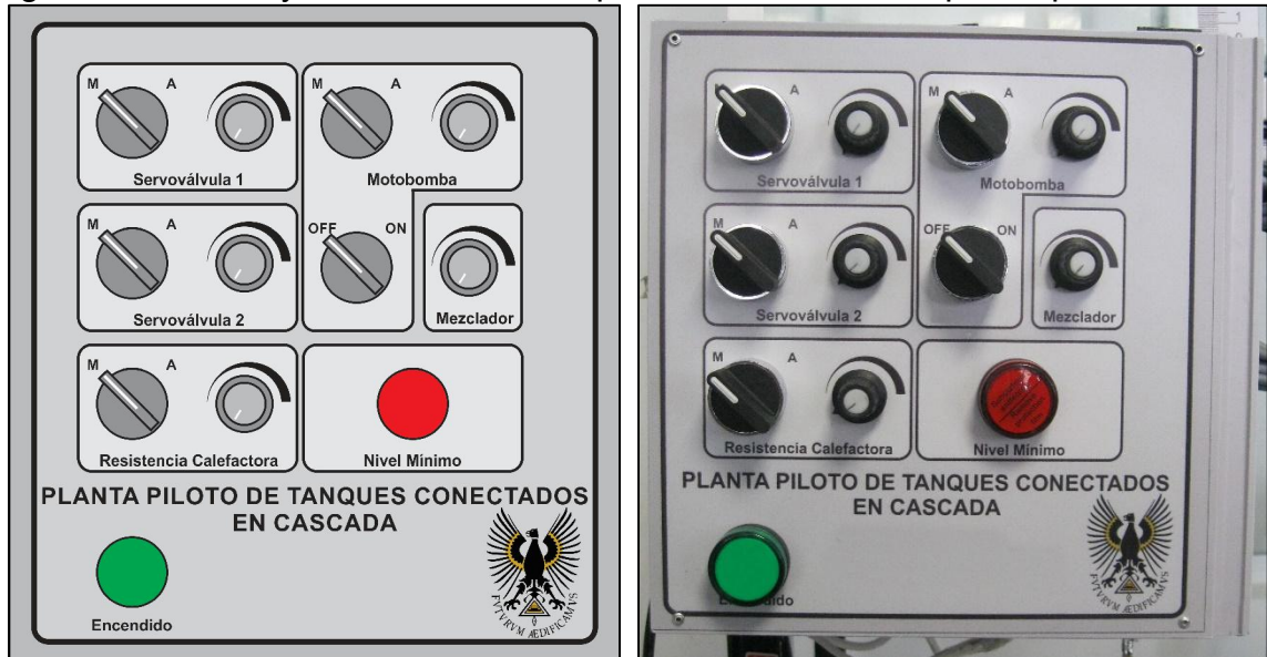
Figura 18. Diseño y resultado final del panel de control de la planta piloto.
