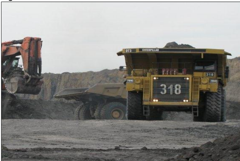
Figura 18. Camión Flota 789C
