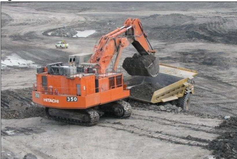
Figura 14. Pala Retroexcavadora EX3600BH
