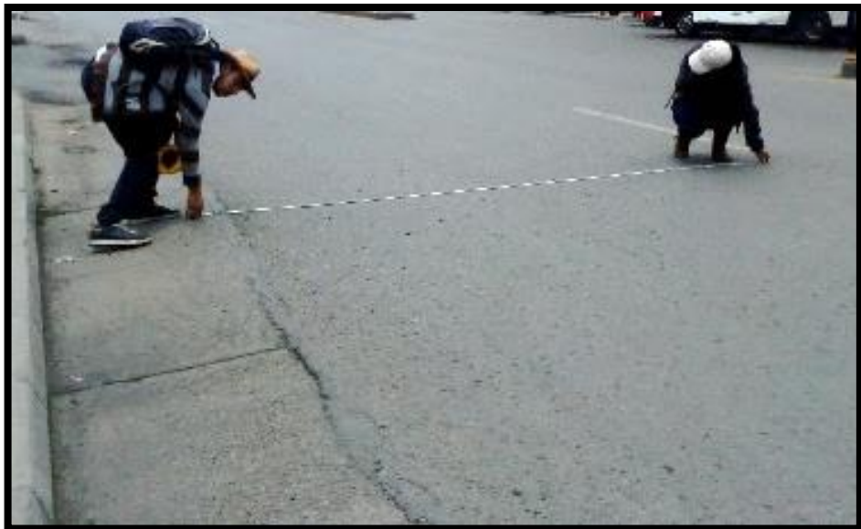
Figura 12. Toma de Ancho Sección Transversal
