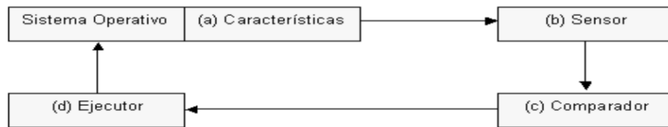
FIGURA 2. LOS ELEMENTOS BÁSICOS DE UN SISTEMA DE CONTROL
