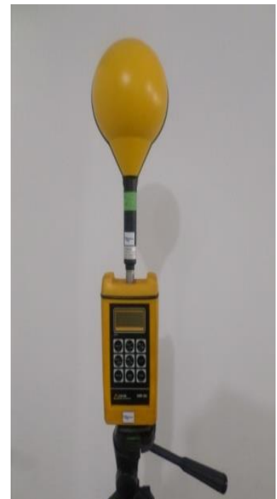
Figura 14. Sonda de campo magnético de banda ancha entre 300 kHz 30 MHz, fuente autor.
