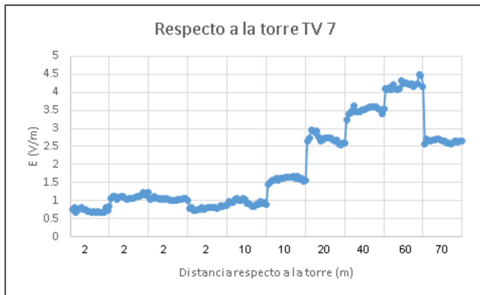
Figura 25. Estación TV 7, puntos medidos con respecto a la base de la torre, fuente autor.
