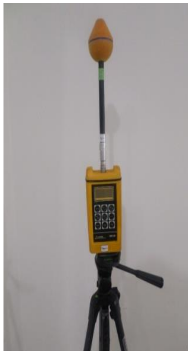
Figura 13. Sonda de campo magnético de banda ancha entre 27 MHz – 1 GHz, fuente autor.
