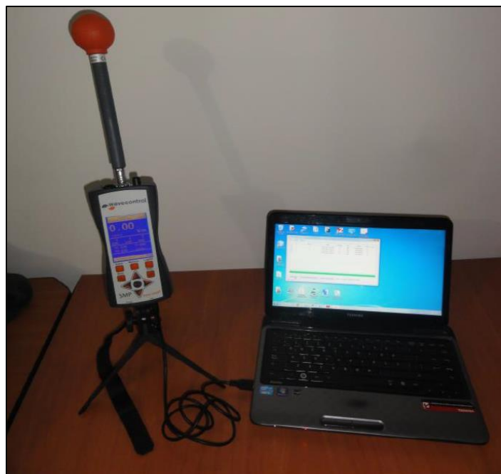
Figura 63. EQUIPO DE SMP conectado a un computador portátil, fuente TES AMERICA ANDINA LTDA.
