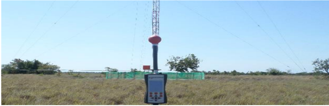
Figura 3. Equipo de medición SMP de WAVECONTROL, fuente autor.
