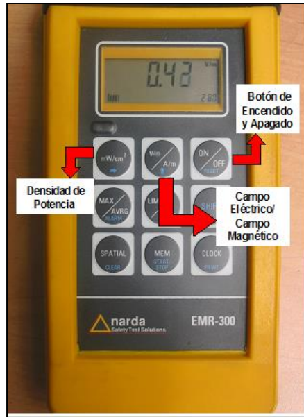
Figura 69. Botón de encendido selección densidad de potencia, selección campo eléctrico y selección campo magnético, fuente TES AMERICA ANDINA LTDA.
