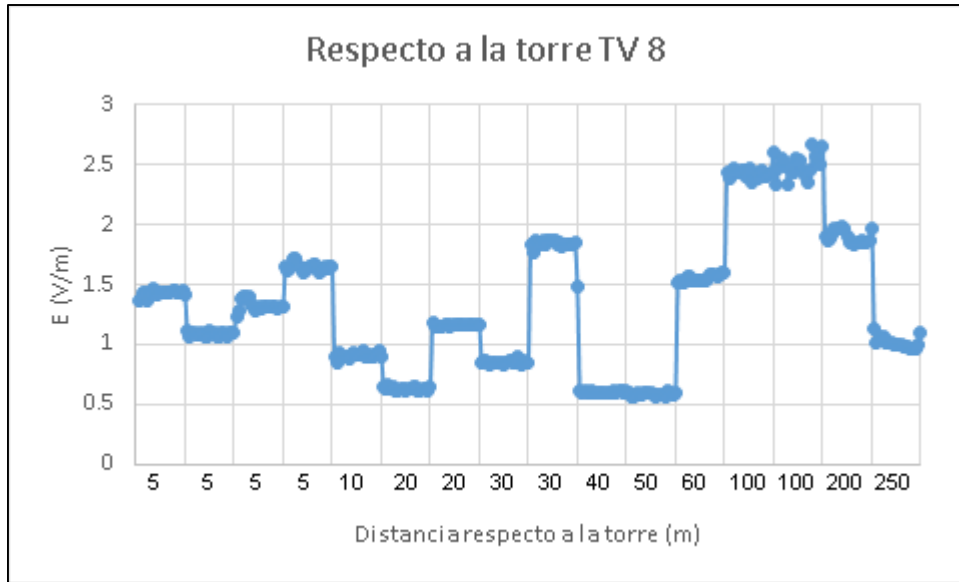
Figura 26. Estación TV 8, puntos medidos con respecto a la base de la torre, fuente autor.
