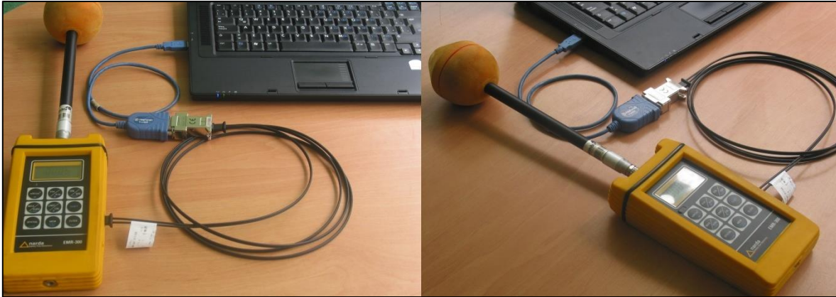
Figura 81. Conexión entre la PC y el equipo NARDA EMR 300, fuente TES AMERICA ANDINA LTDA.
