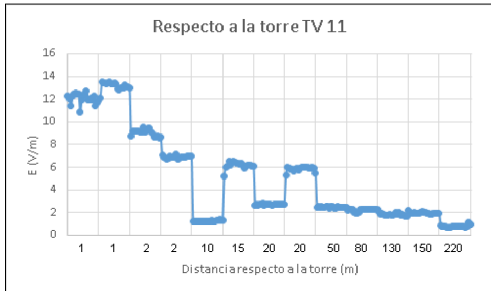
Figura 29. Estación TV 11, puntos medidos con respecto a la base de la torre, fuente autor.
