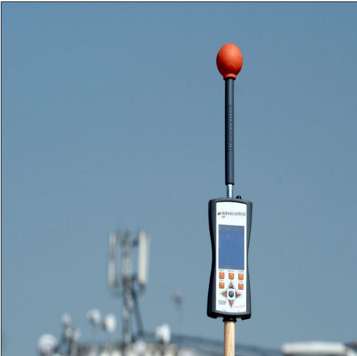
Figura 11. Medidor de campo y sonda de campo eléctrico. [17]
