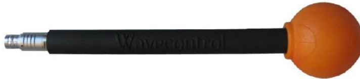
Figura 49. Sonda de campo eléctrico WPF3, fuente TES AMERICA ANDINA LTDA.
