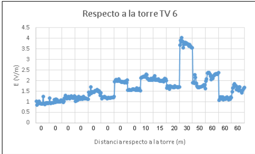
Figura 24. Estación TV 6, puntos medidos con respecto a la base de la torre, fuente autor.
