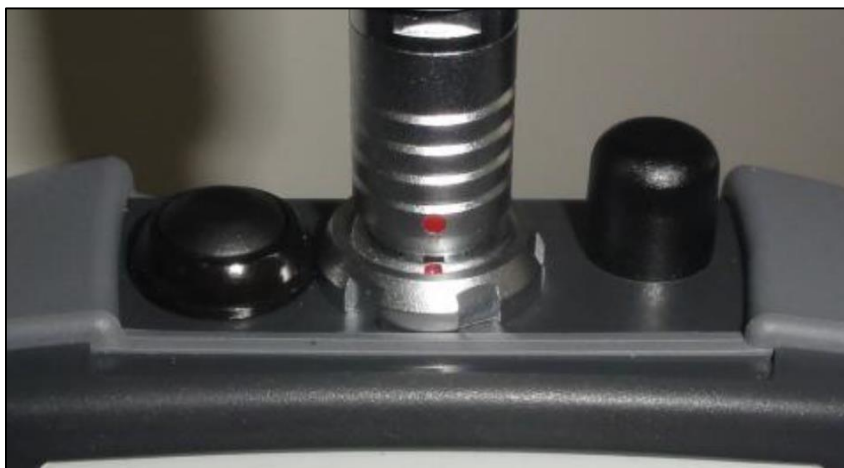
Figura 54. Conexión final entre el equipo y la sonda, fuente TES AMERICA ANDINA LTDA.
