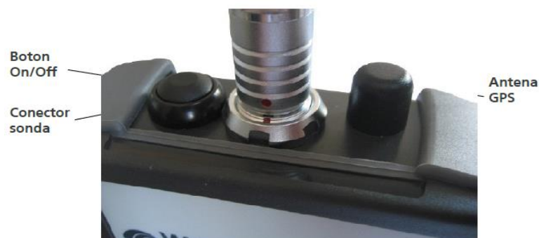
Figura 55. Vista superior del equipo SMP de WAVECONTROL, fuente TES AMERICA ANDINA LTDA.
