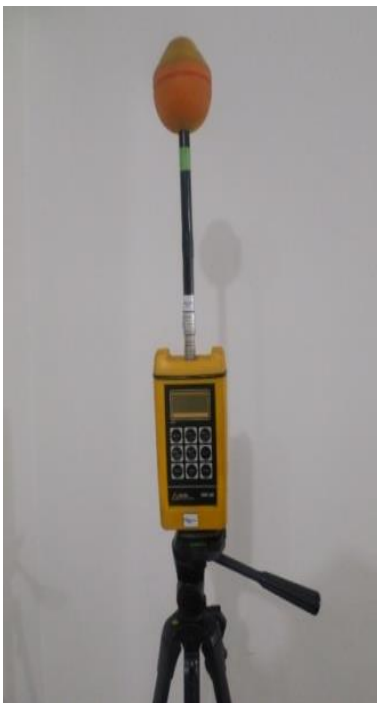
Figura 12. Sonda de campo eléctrico de banda ancha entre 100 kHz – 3 GHz, fuente autor.
