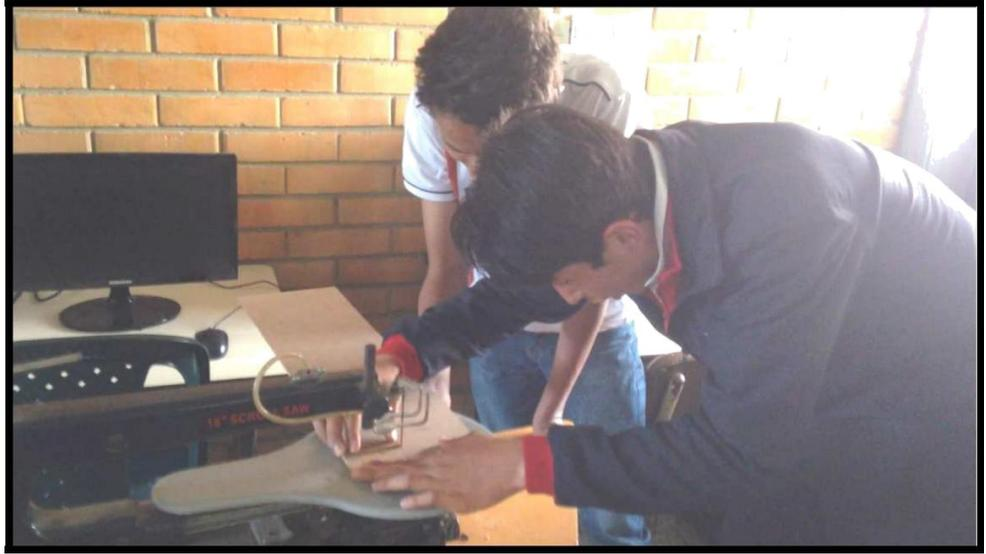
**Imagen 22:** Corte de material para la construcción de la carcasa del tanque.
