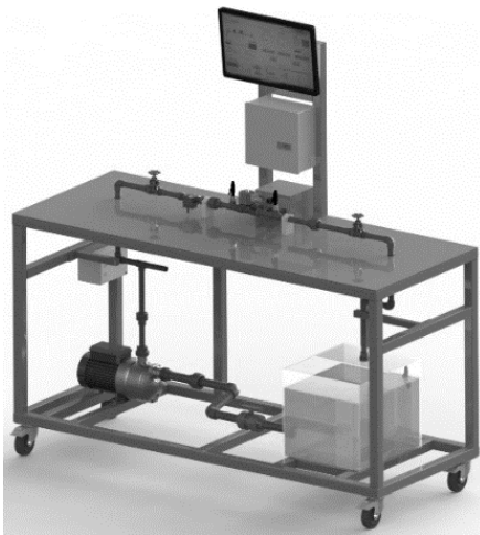
Figura 7. Estructura y elementos del banco, CAD.
