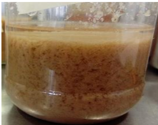
Figura 30. Lodo bentonita (8%) + 0,5 g NPA-i-PAM, pH > 11
