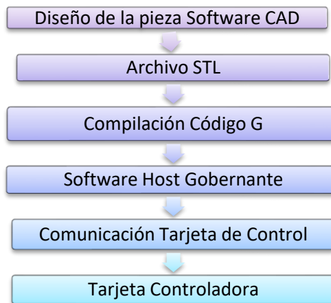
Figura 6-1. Diagrama de flujo de información para el control del sistema.
