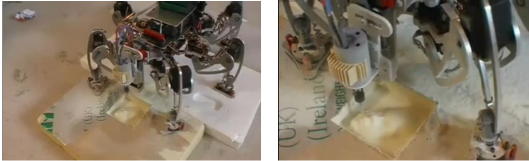
Figura 2-15. Robot hexápodo realizando operaciones de mecanizado
