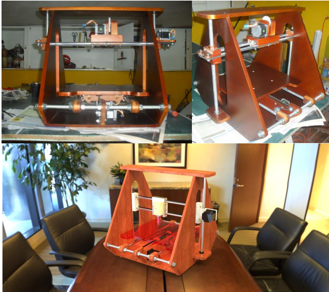
Figura 7-3. Abajo el sistema mecánico diseñado renderizado en Keyshot 3 y Arriba la impresora construida.
