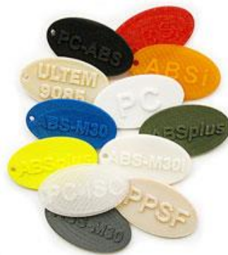
Figura 2-10. Diferentes tipos de Termoplásticos utilizados en impresión 3D FDM
