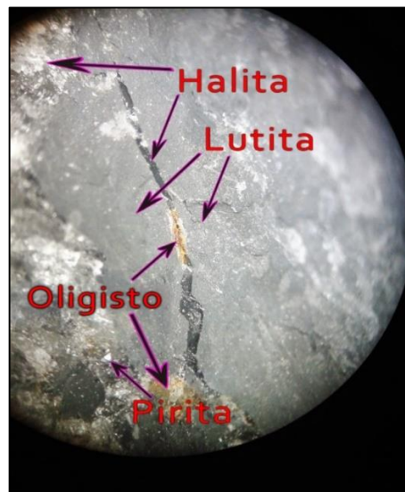
Foto 4: Fisura en lutita rellena de Halita y Hematita.
